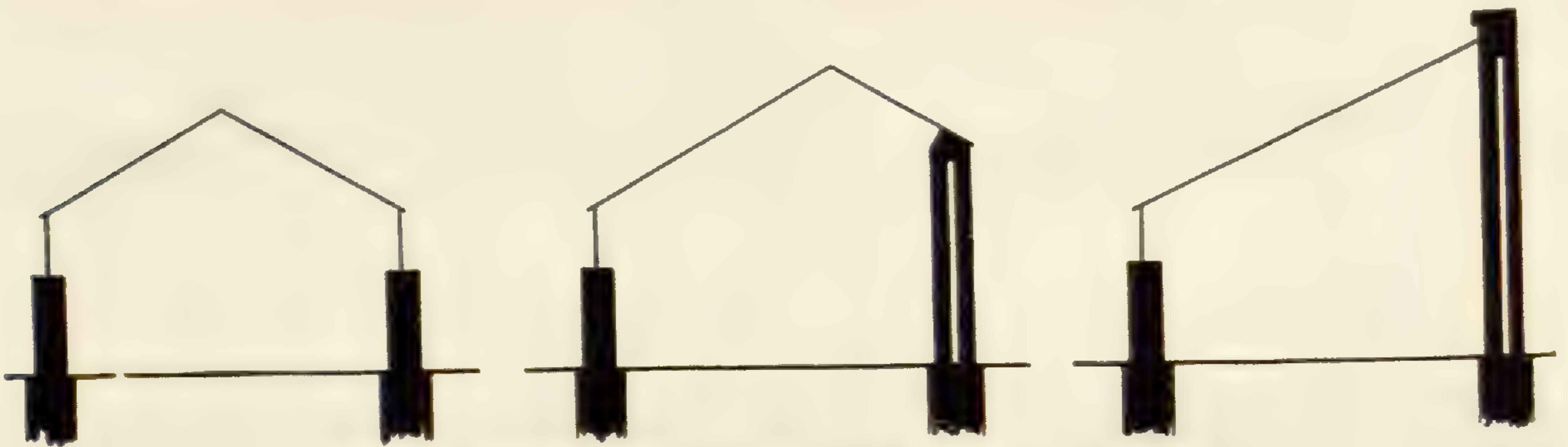
Fig. 236. Orchideenhäuser-Querschnitte von drei Typen.
